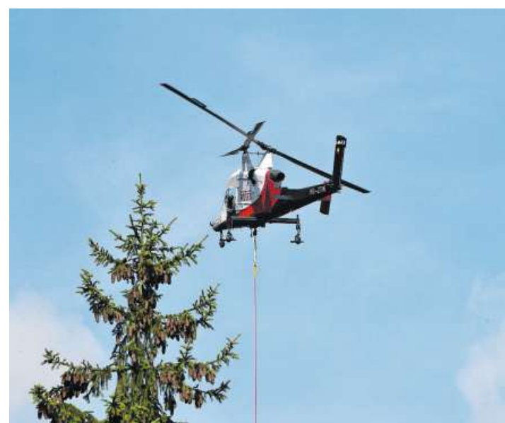
Der Helikopter hat eine Hebeleistung 2,7 Tonnen.
